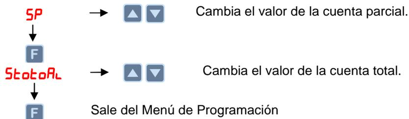
**Nota1:** Si se mantiene presionada una de las teclas ▲ ▼, luego de un momento el valor comenzara a modificarse rápidamente. Si no se presiona ninguna tecla, pasado algunos segundos sale del Modo Programación, volviendo al Modo de Control.
